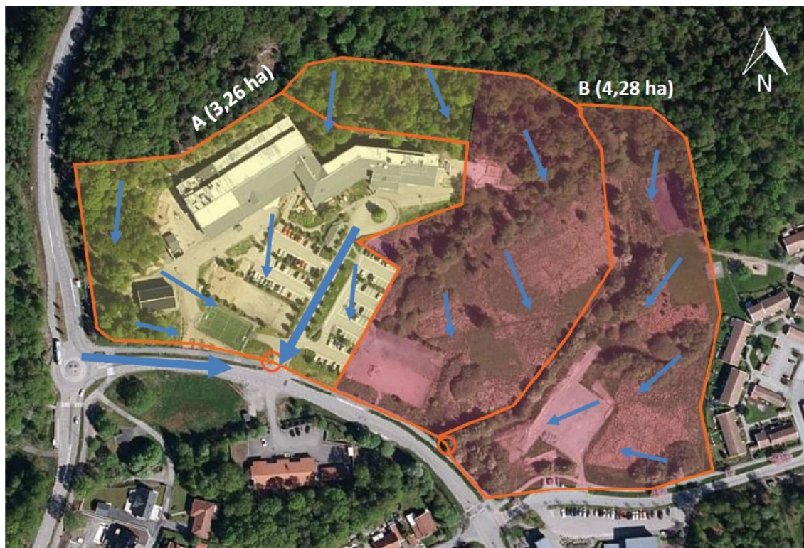
Bild 17. Avrinningsområden i gult och rosa, ytliga avrinningsvägar med blåa pilar, fastighetsgränser i orange och utsläppspunkter inom planområdet med orange ring.
