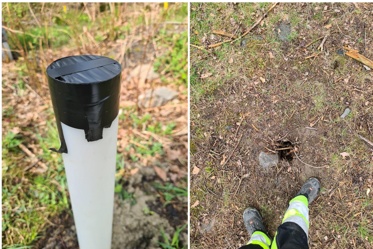
Figur 10. Till vänster: NC2001 - lock försvunnit. Nu utförda mätningar påverkade av regnvatten. Till höger: NC2010 har gångats av och transporterats bort från platsen av okänd anledning – mätning ej möjlig.
