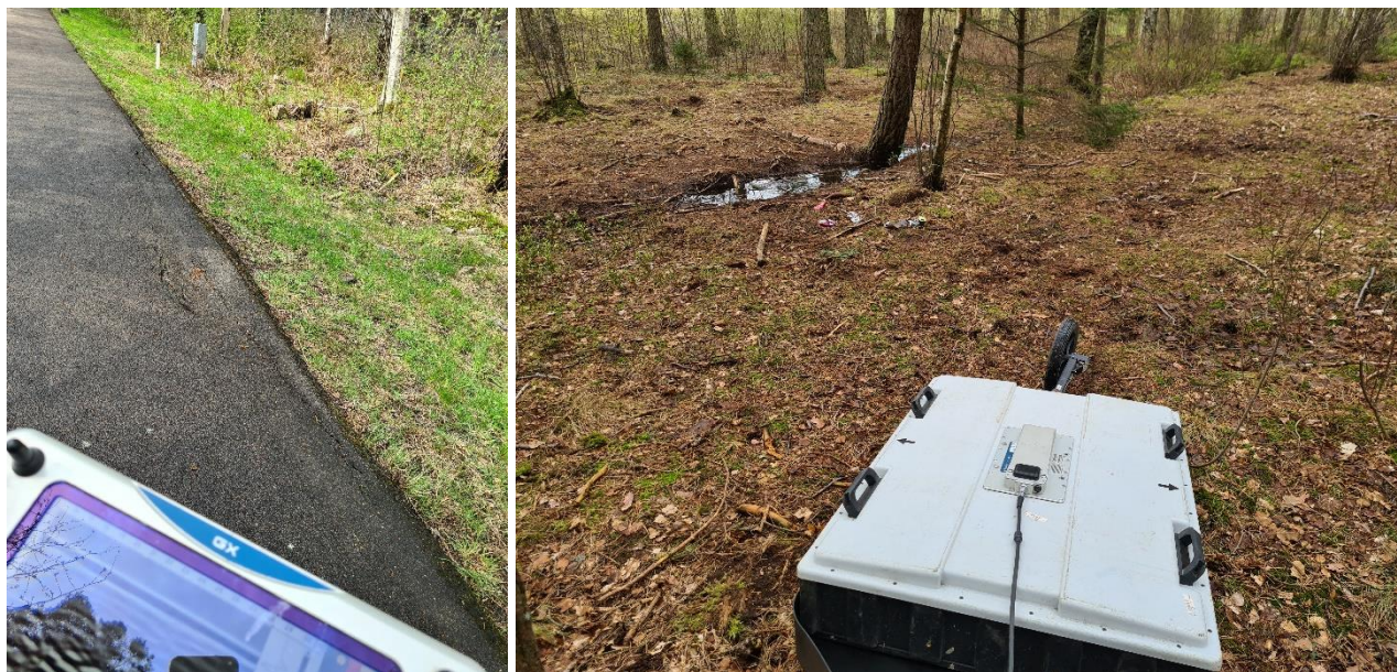
Figur 6. Malå GX-system med fälldator (till vänster) och 80 MHz sändar- och mottagarantenn monterade i ljusgrå "pulka". Längs bak på pulkan finns ett mätjul som arbetar tillsammans med inbyggd GNSS.
