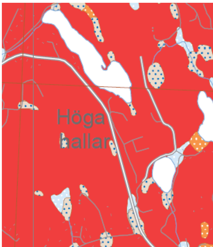
Figur 3. Urklipp från SGUs jordartskarta för området. Rödmarkerat betyder urberg, blåprickat kärrtorv, vita prickar mot ljusblå botten sandig morän samt vita prickar mot orange botten postglacial sand/finsand (SGU, september 2016).
