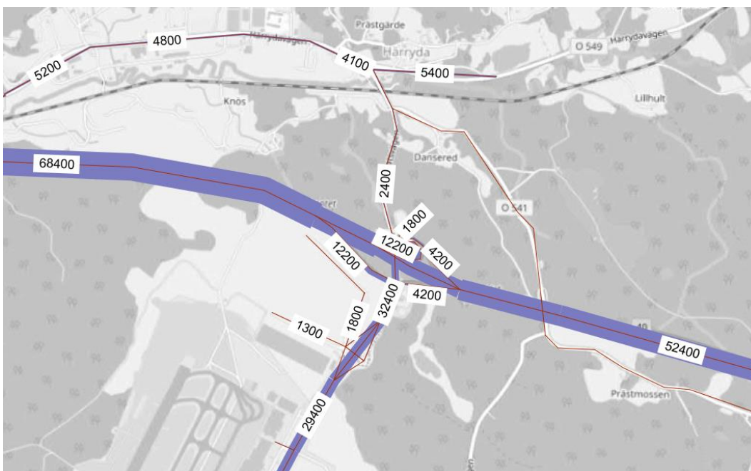
Figur 19. Trafikflöden nollalternativ 2040 närbild, fordon/vardagsdygn.
