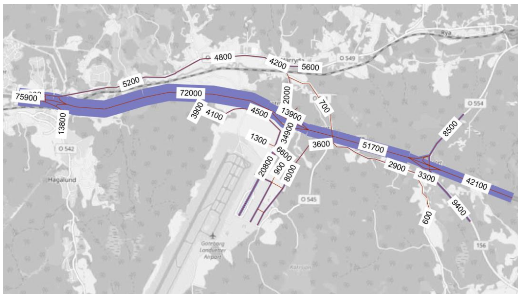
Figur 31. Trafikflöden scenario 2A översikt, fordon vardagsdygn.
