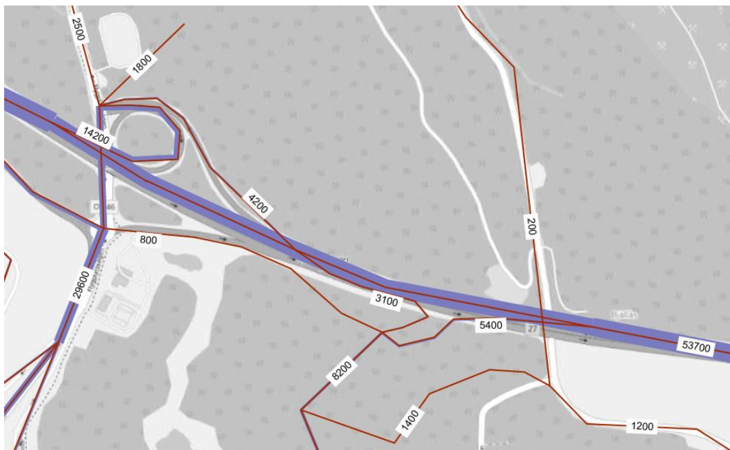
Figur 39. Trafikflöden scenario 2C ytterligare närbild, fordon vardagsdygn.
