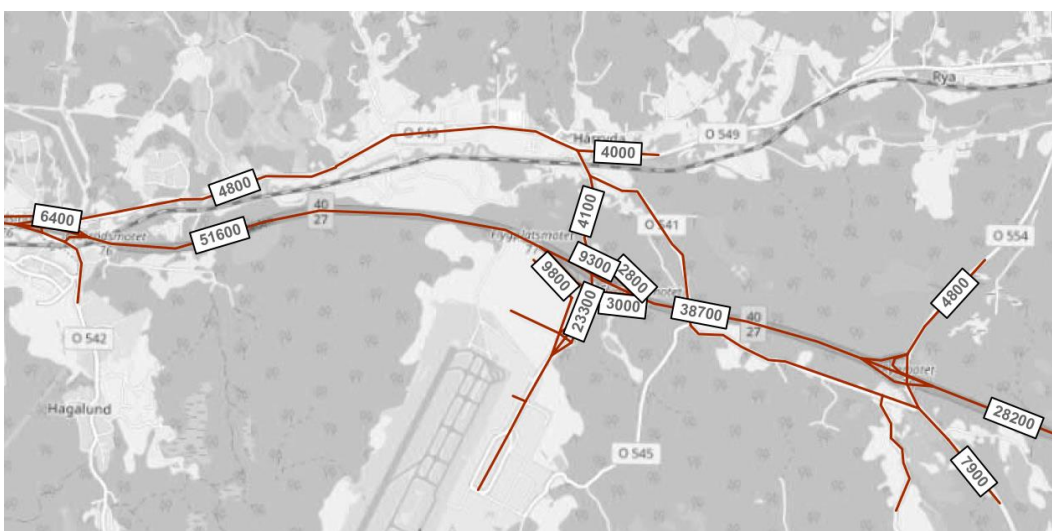
Figur 17. Trafikmätningar uppräknade till nulägesår 2019. Källa: Trafikverkets trafikflödeskartor samt specialmätning vid Flygplatsmotet.
