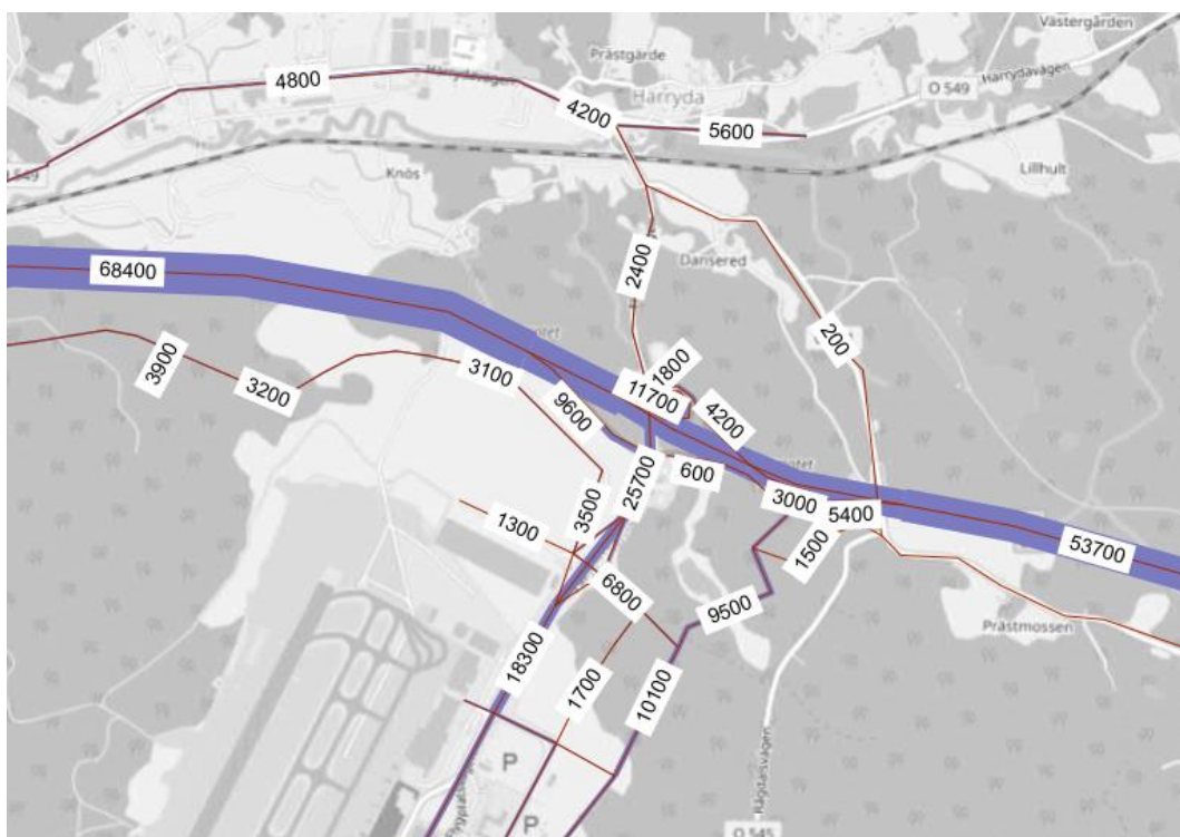
Figur 42. Trafikflöden scenario 2D närbild, fordon/vardagsdygn.
