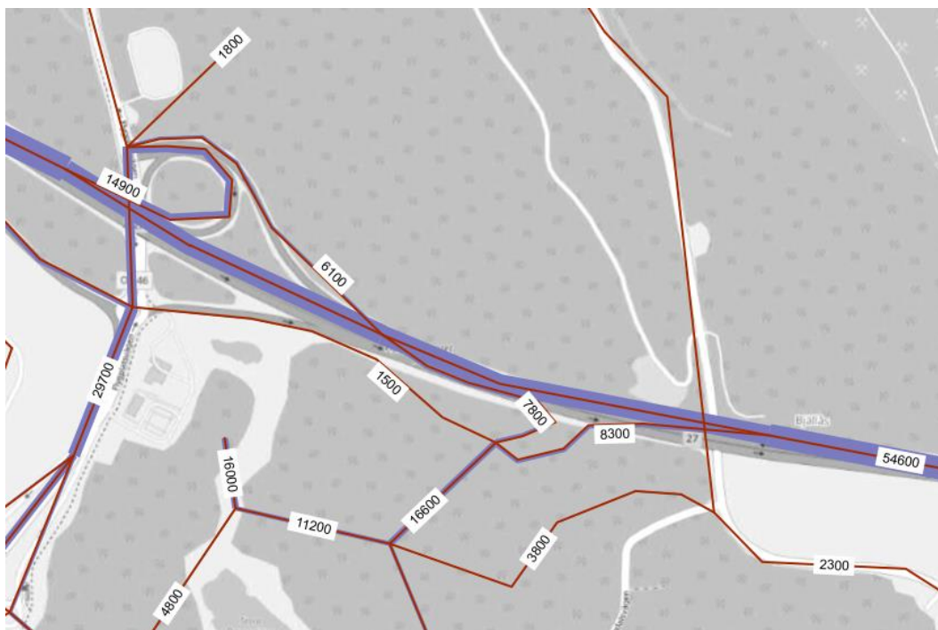
Figur 57. Trafikflöden scenario 4C ytterligare närbild, fordon/vardagsdygn.
