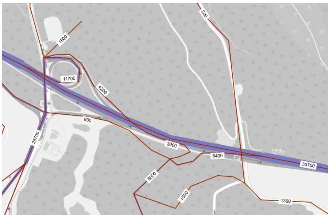
Figur 43. Trafikflöden scenario 2D ytterligare närbild, fordon/vardagsdygn.
