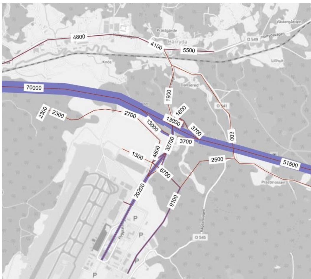
Figur 26. Trafikflöden scenario 1A närbild, fordon/vardagsdygn.
