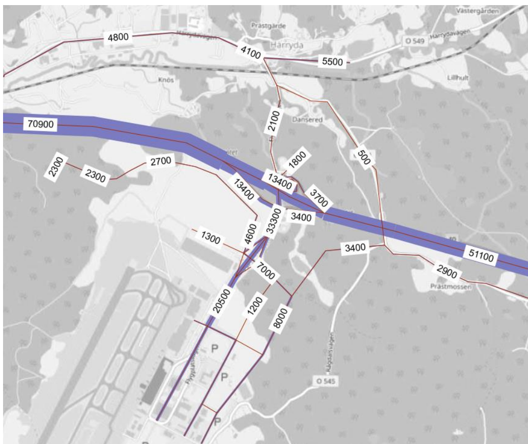
Figur 46. Trafikflöden scenario 3A närbild, fordon/vardagsdygn.
