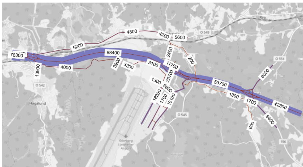
Figur 41. Trafikflöden scenario 2D översikt, fordon vardagsdygn.
