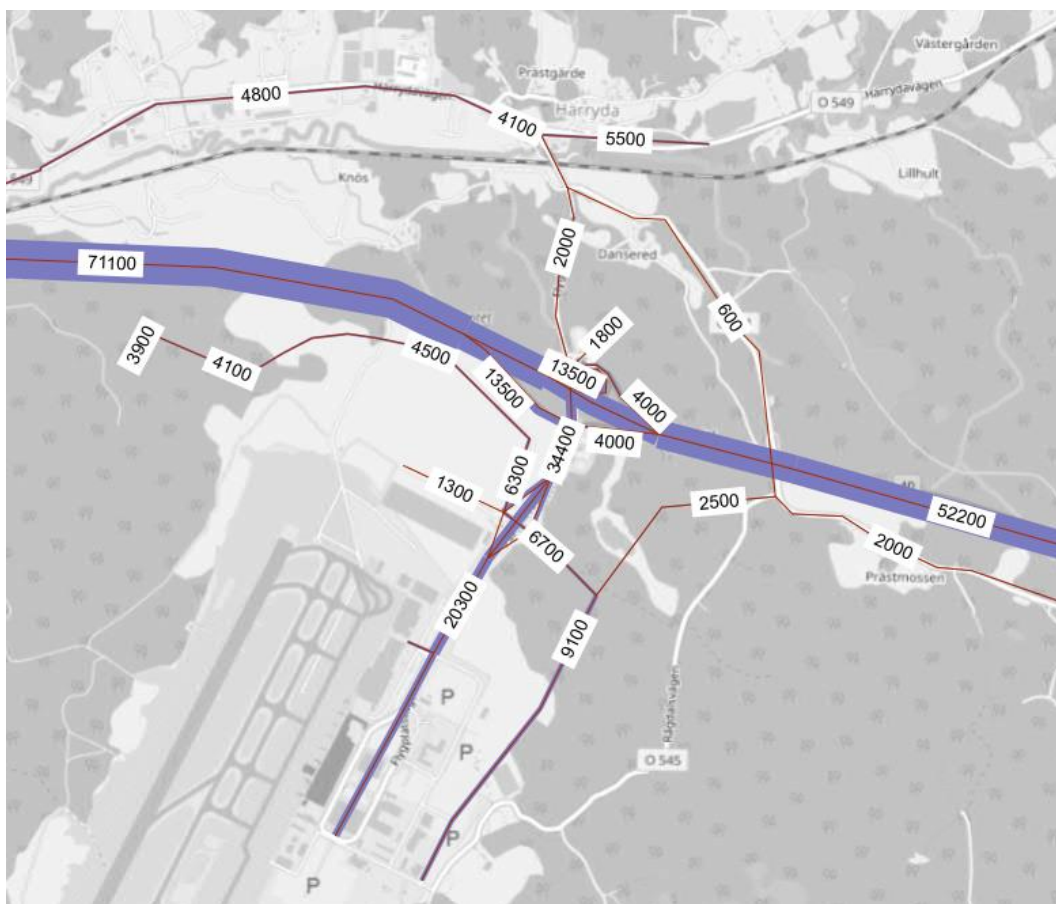
Figur 29. Trafikflöden scenario 1B närbild, fordon/vardagsdygn.
