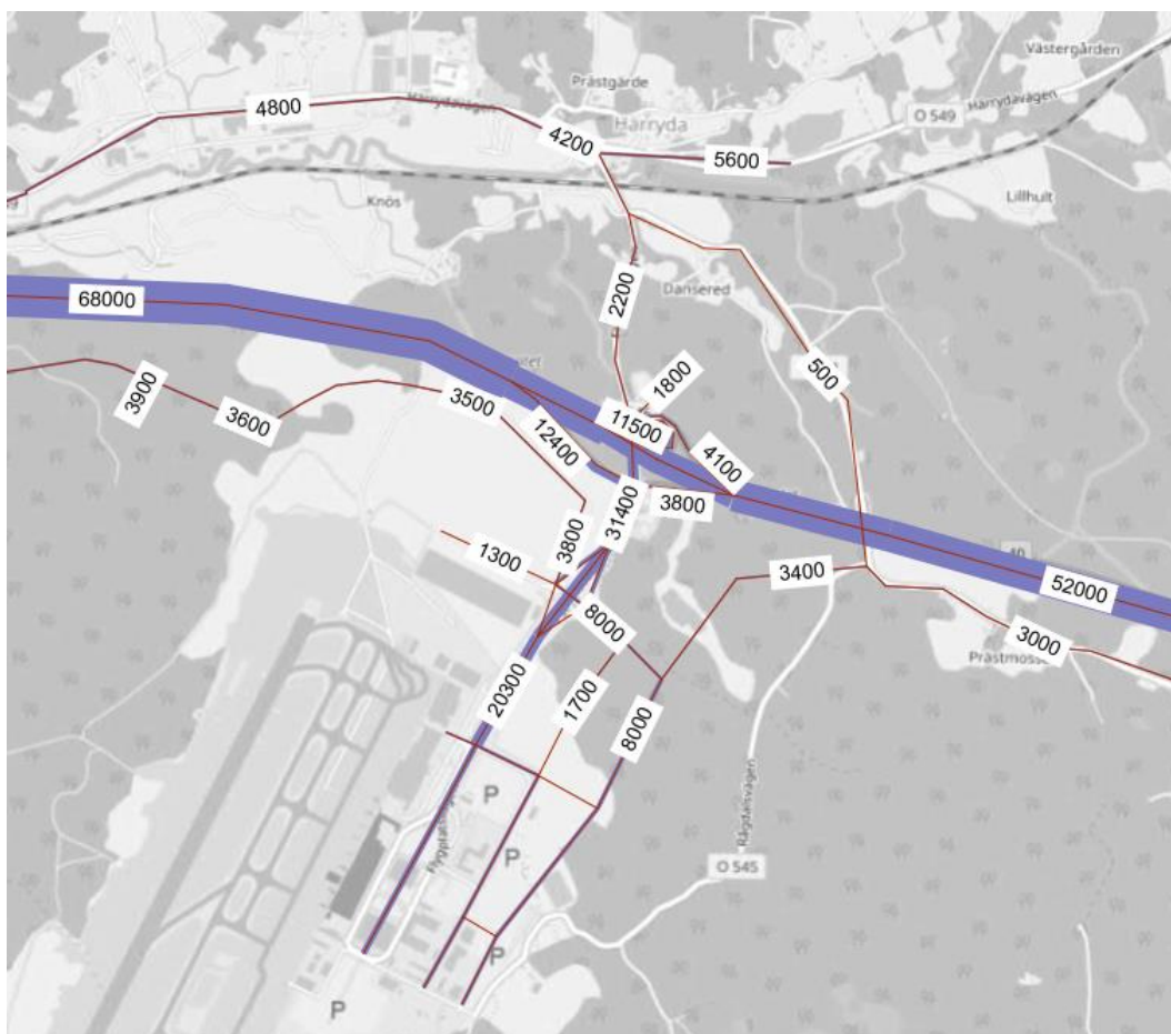
Figur 35. Trafikflöden scenario 2B närbild, fordon/vardagsdygn.
