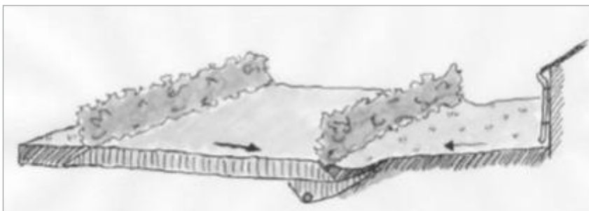
Figur 26. Skiss exempel på utformning av svackdike (Illustration: Norconsult)
