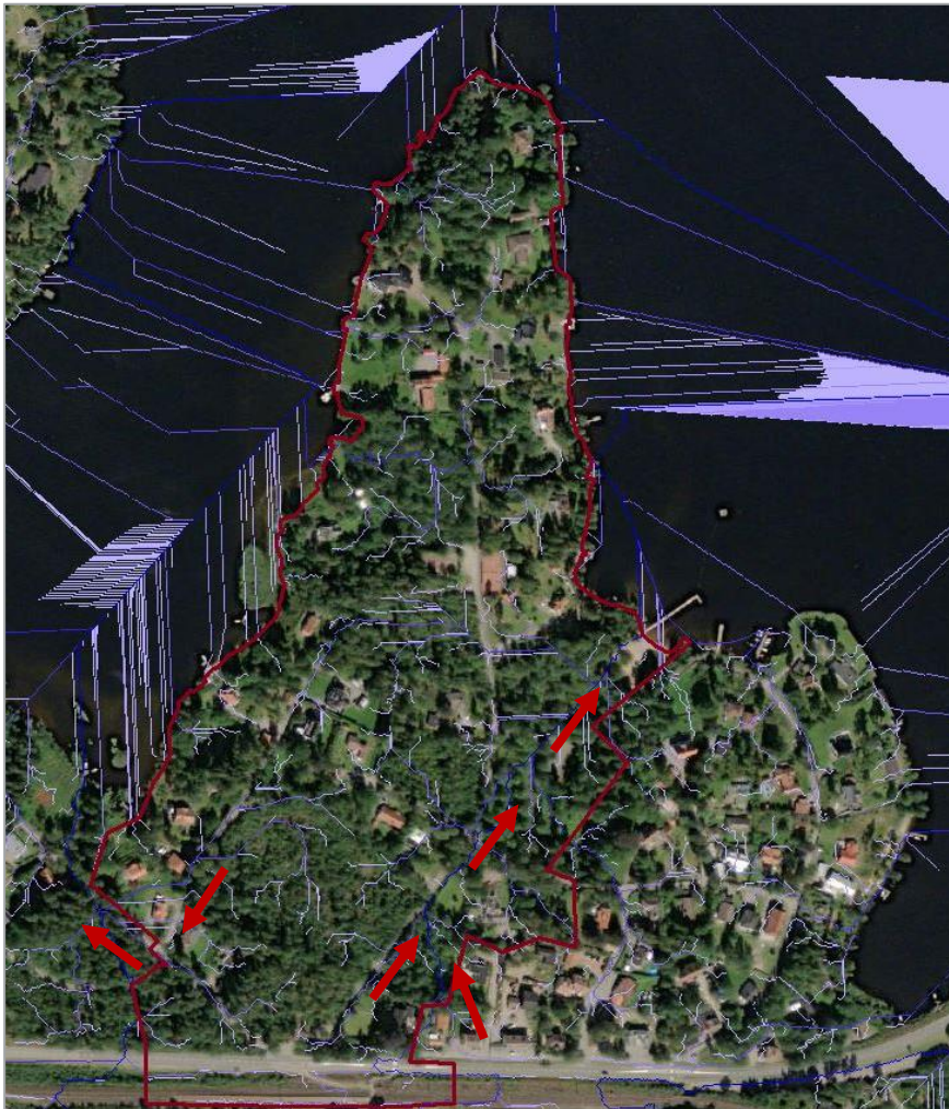
Figur 35. Avrinningsvägar vid skyfall, flödesriktning markerat med röda pilar
