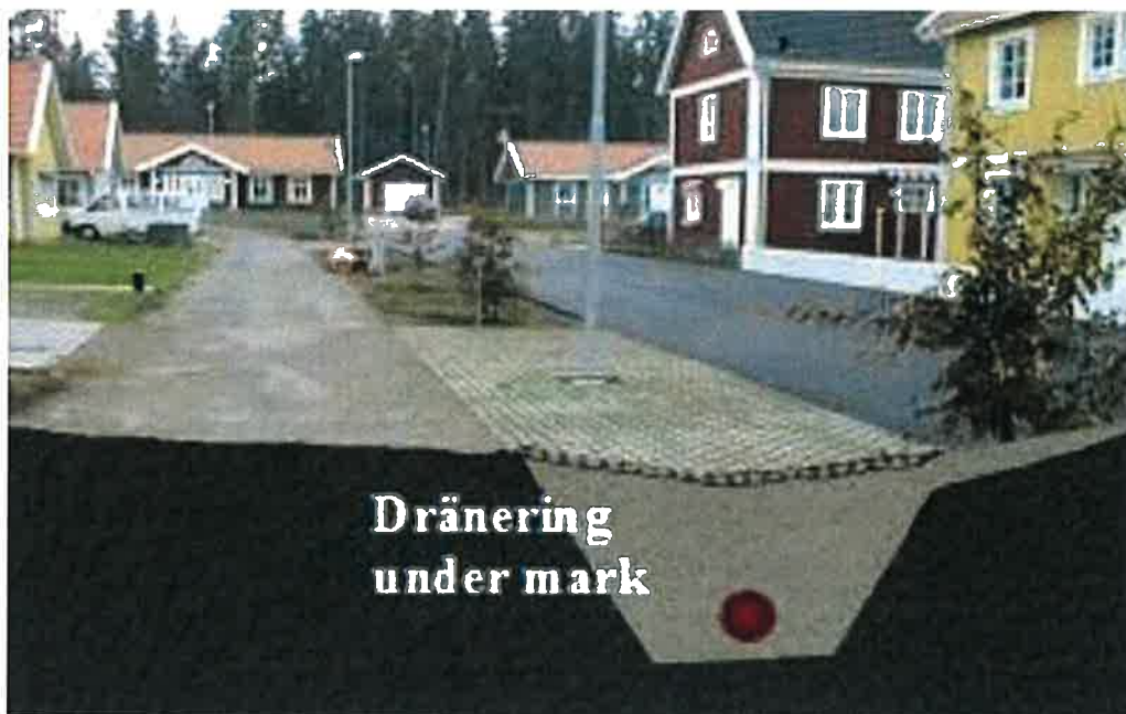
Figur 15. Makadamfyllt dike med dräneringsledning.
