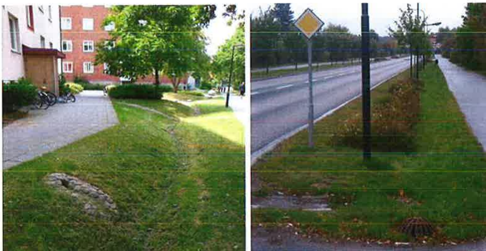
Figur 14. Exempel på svackdiken.
