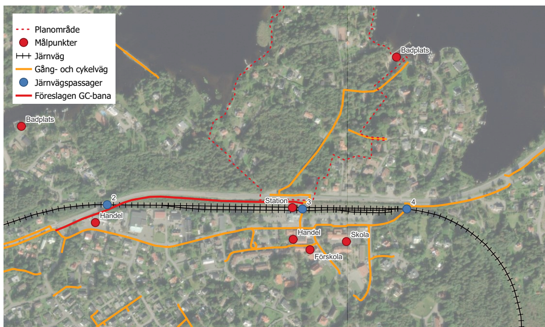
Figur 10. Föreslagen sträckning för gång- och cykelbana längs Boråsvägen mellan Hindås station och korsningen Hindås stationsväg. Ortofoto: ESRI.
