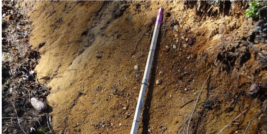
Figur 4. Skärning vid en infartsväg i väster där man kunde se den sandiga moränen med sten och block. (Träpinnen har 0,2 m avstånd mellan svarta linjer.)
