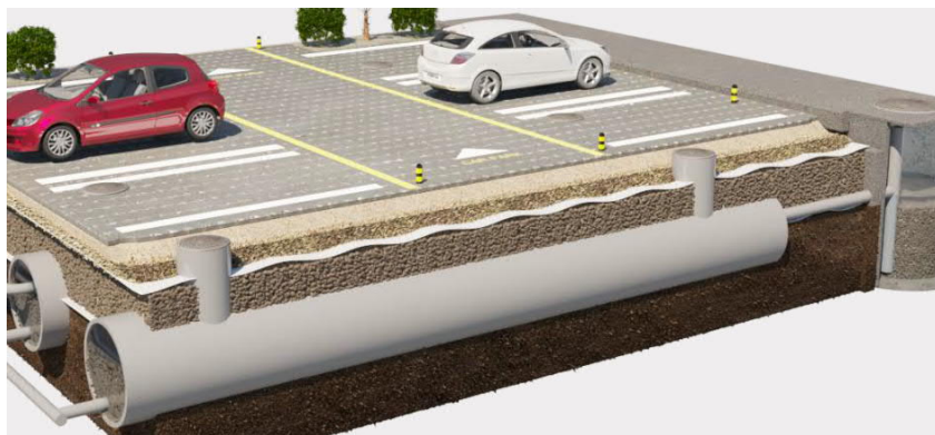
Figur 2. Granulatfyllda rörmagasin för fördröjning och rening av dagvatten. Bildkälla: Weric AB.
