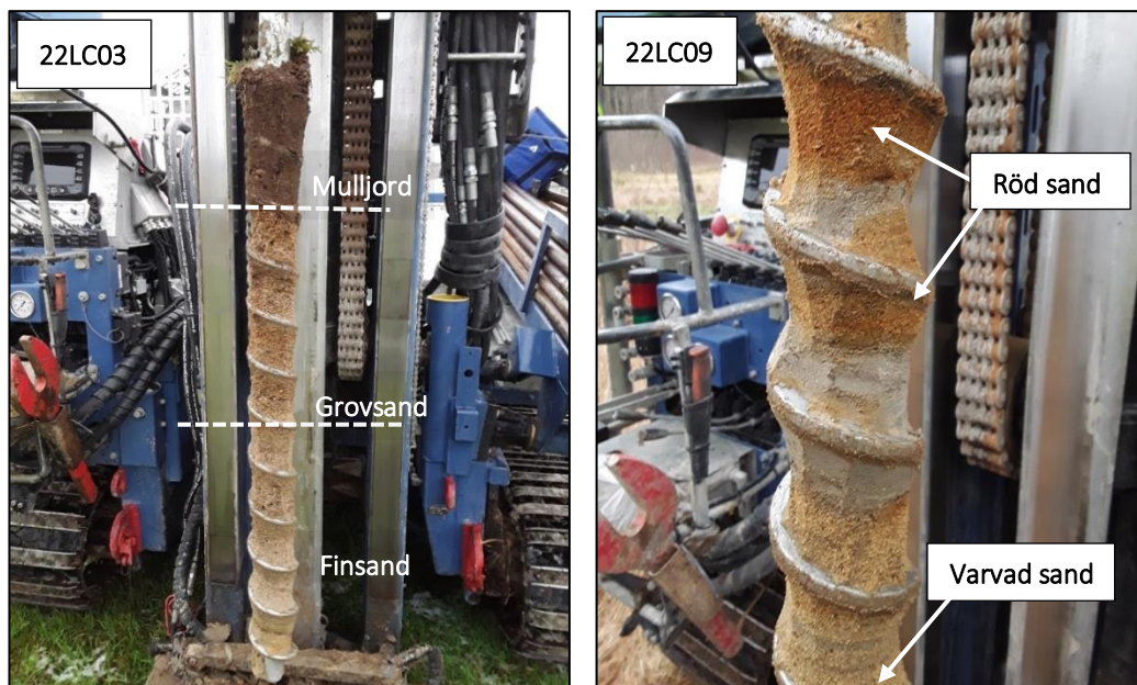
Figur 5. Exempel på skruvar där sand dominerade, där bilden till vänster är tagen i punkt 22LC03 på 0–1 meters djup och bilden till höger är tagen i punkt 22LC09 på 1–1,3 meters djup.
