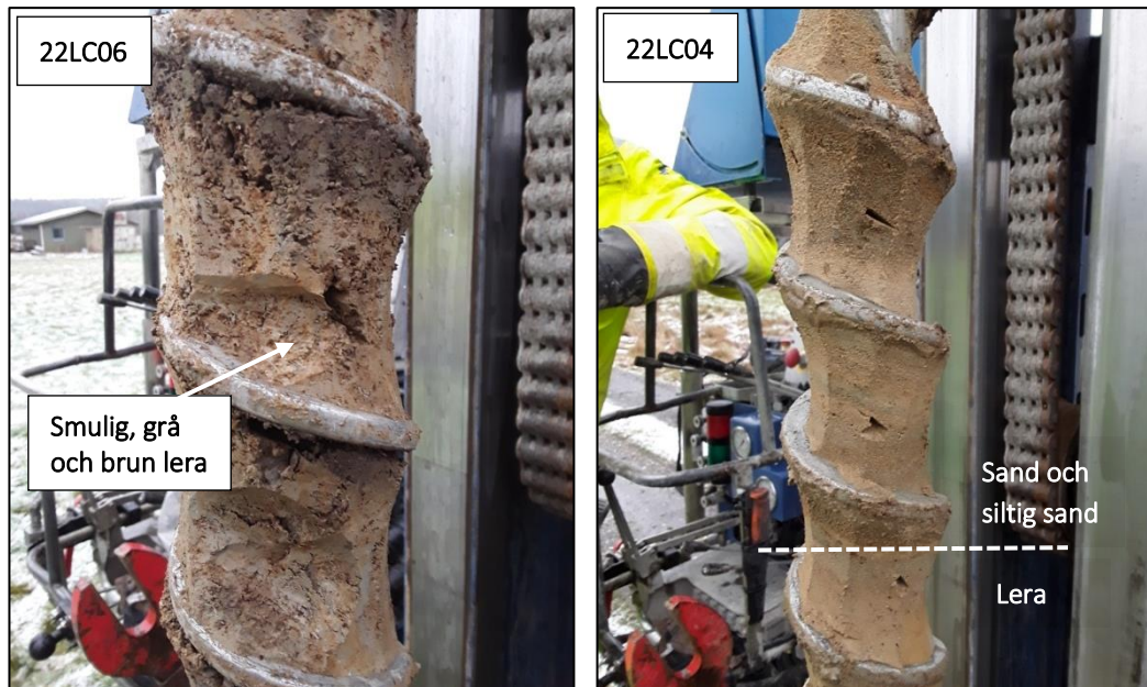
Figur 6. Exempel på skruvar där sand dominerade, där bilden till vänster är tagen i punkt 22LC06 på 0,1–0,5 meters djup och bilden till höger är tagen i punkt 22LC04 på 1–1,4 meters djup.
