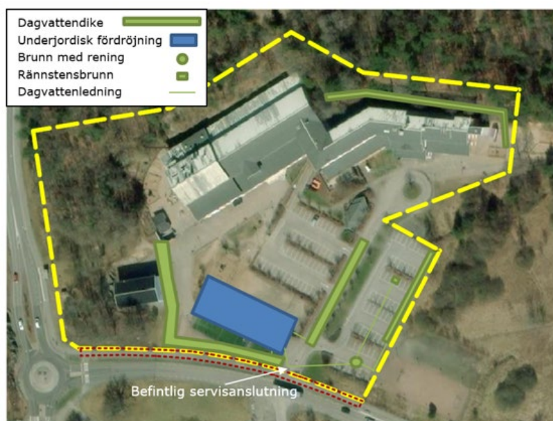
Bild 9. Föreslagna anläggningar för dagvattenhantering
