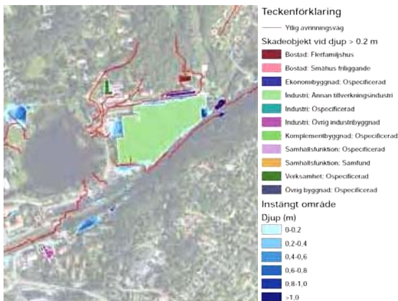
Skadeobjekt vid skyfall utmed Mölnåsaån.
