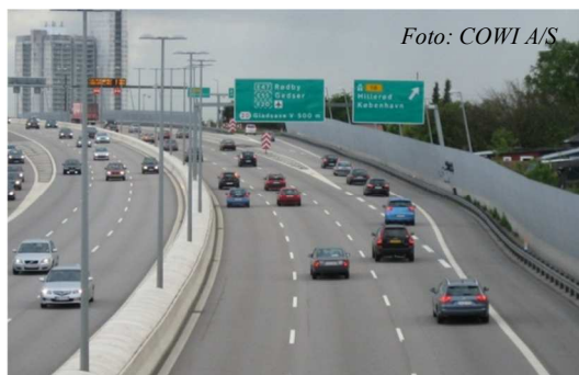
Figur 19 Ytterligare exempel på bullerskyddsskärm längs motorvägen M3 runt Köpenhamn.
