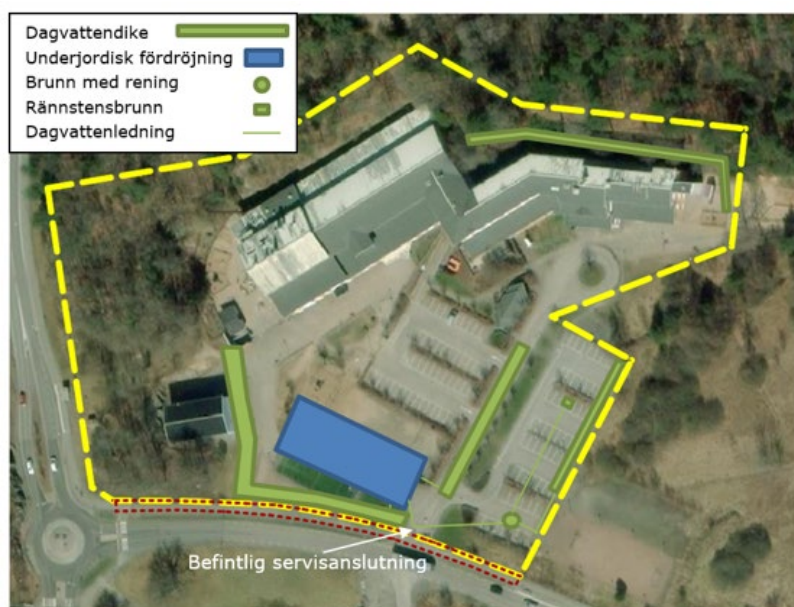
Bild 9. Föreslagna anläggningar för dagvattenhantering
