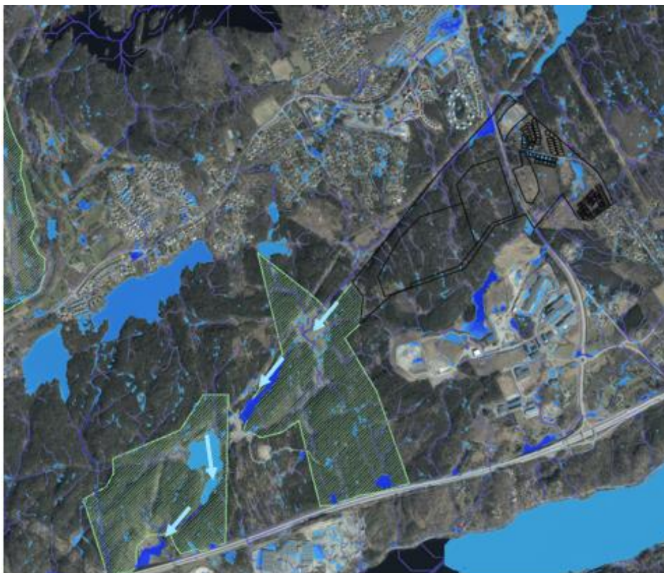
Figur 9. En övergripande bild av dagvattnets rinnväg genom Naturreservatet. Vattnet rinner till Store mosse, vidare till sjön Lilla Bråtatjärnen och därefter ut ur naturreservatet via Bråtabäcken. Bildkälla: Scalgo Live modifierad i AutoCAD.
