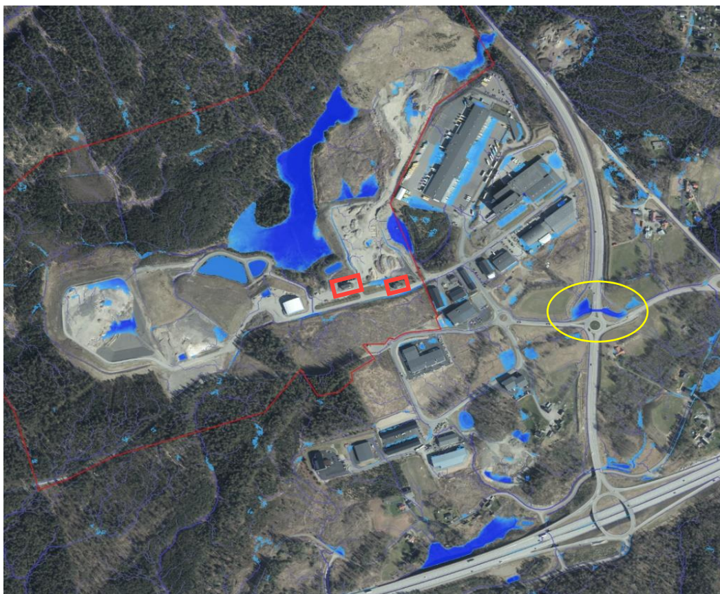
Figur 15. Simulering av 50 mm nederbörd, området visar del av Boråsvägen samt Partillevägen fram till byggnader av större vikt, markerat i rött, samt översvämmat stråk, vilket är en gångtunnel, i gul cirkel. Bildkälla: Scalgo Live
