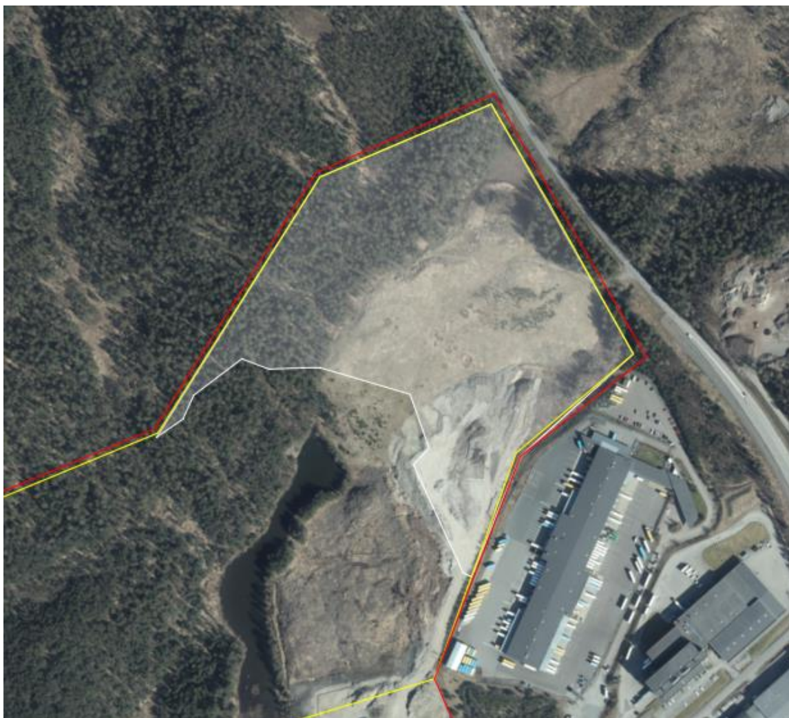
Figur 17. Visar i vitt det område som markkarterats från ortofoto, markanvändningen beskrivs närmare i Tabell 3. Avrinningsområde under Partillevägen och vidare mot nordost. Bildkälla: Scalgo Live modifierat i AutoCad.
