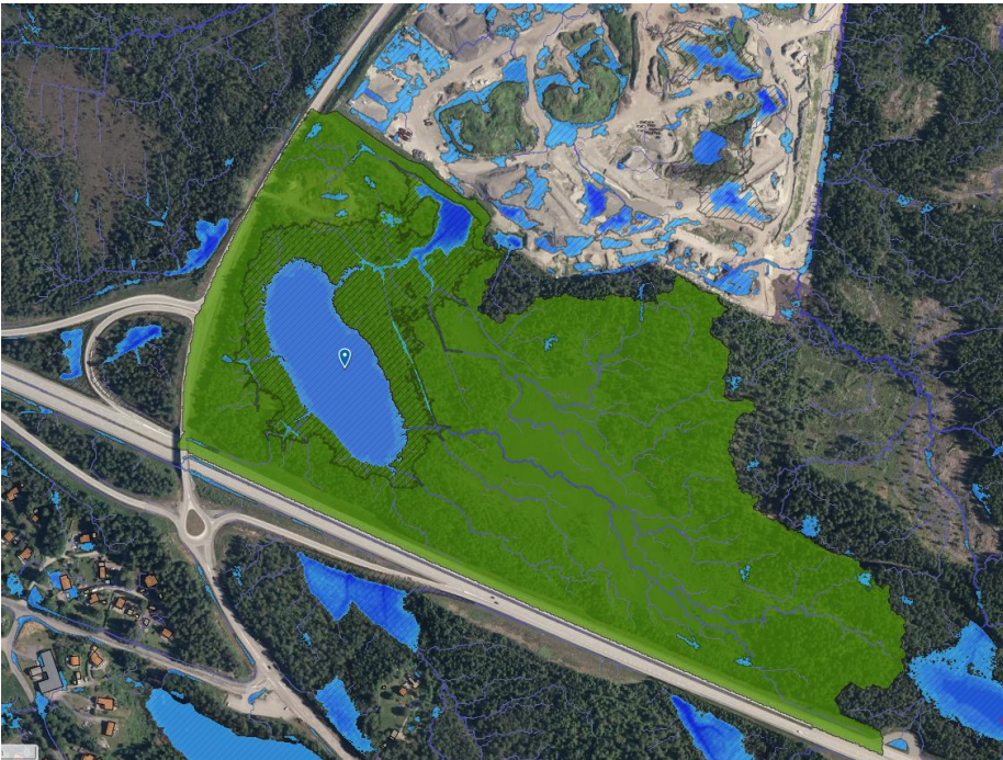
Figur 7. Rörtjärnen ansluten till diket "Fäxhult-diket" och har ett avrinningsområde på cirka 0,27 km 2 (grön yta i figuren).
