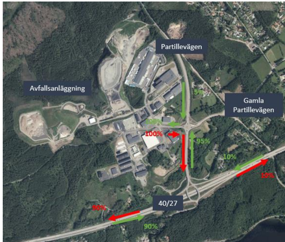
Figur 3. Kartbild över riktningfördelningen av in- och uttransporter från deponiverksamheten 3 . Intransporter markeras med grönt och uttransporter med rött.
