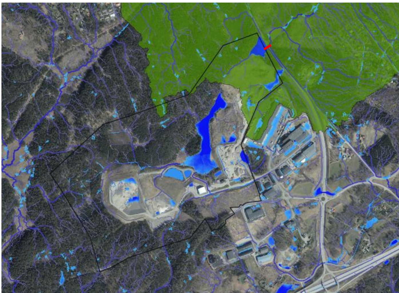
Figur 7. Avrinningsområde till Natura-2000 område Maderna , avrinningsområdets utredning inom fastigheten uppgår till 11 ha. Vägtrumma under Partillevägen som har tagits bort från simulering i Scalgo visas som tjockare röd linje. Svart linje visar fastighetsgräns. Bildkälla: Scalgo Live
