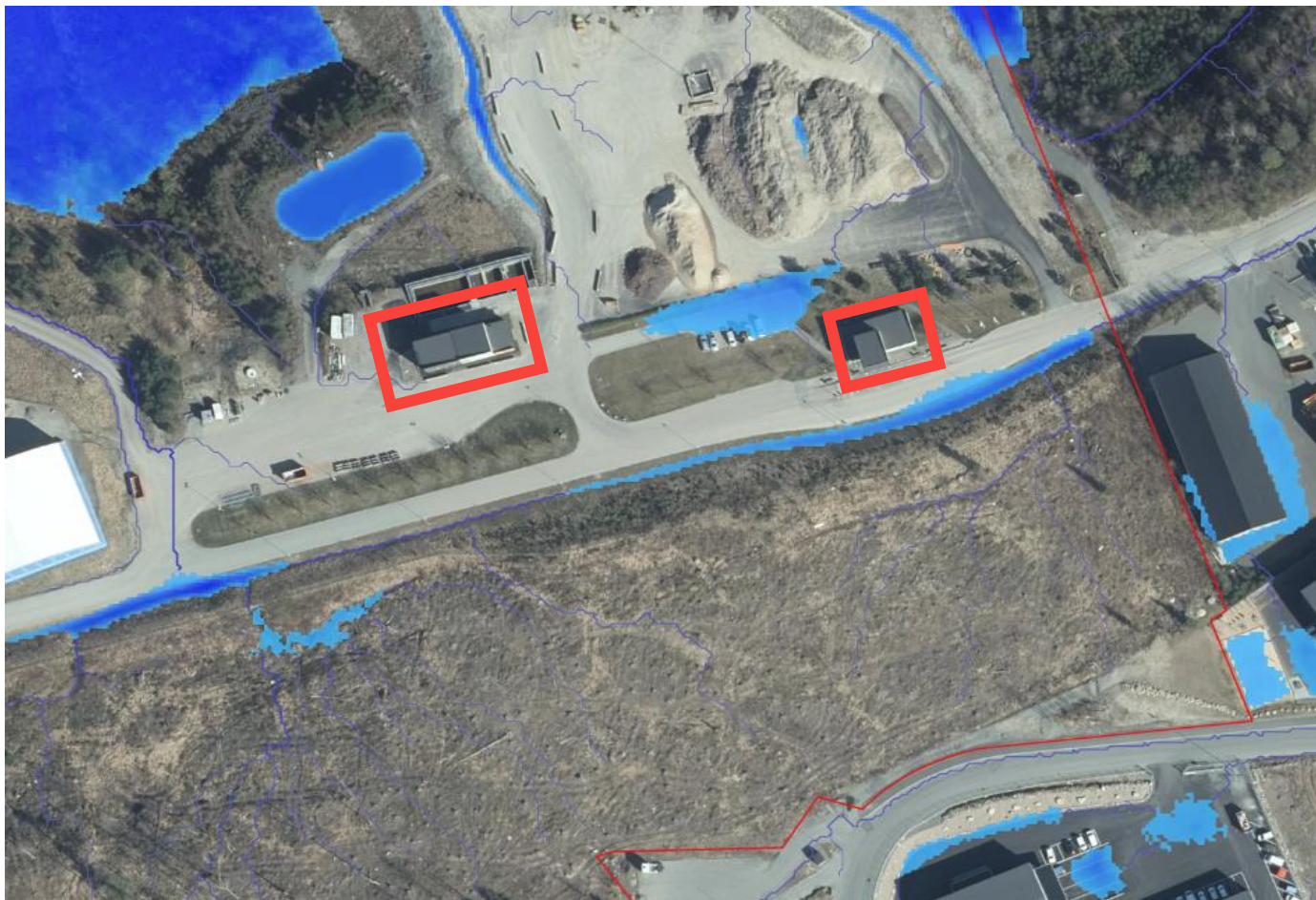
Figur 16. De två byggnaderna inom fastigheten som inte bör översvämmas, den ena inrymmer kontor, en fordonsväg etc och den andra inrymmer ett vattenreningsverk. Tillgängligheten nära byggnaderna anses god, ingen risk för översvämmning vid simulerade regn. Bildkälla: Scalgo Live
