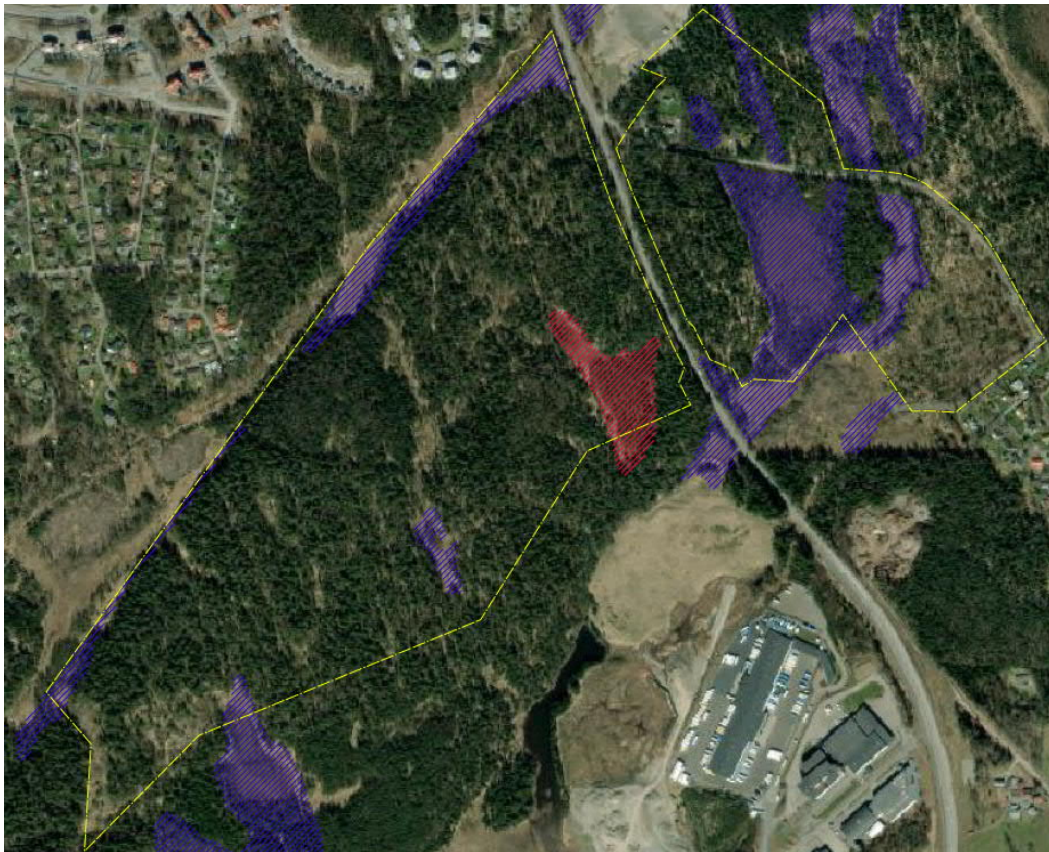
Figur 12. Torvområden som sticksonderats under geoteknisk utredning. Blåa områden visar torvområden inom och i närheten av planområdet. Rött område visar torvmark med mer än 5 m torvdjup.
