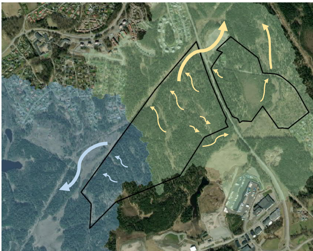
Figur 13. Planområdet markerat med svart linje; avrinningsområde till Natura 2000 i grönt och avrinningsområde till naturreservat Brätaskogen i blått. Pilar visar ungefärlig flödesriktning. Bildkälla: Underlag från Scalgo Live bearbetat i Autocad.
