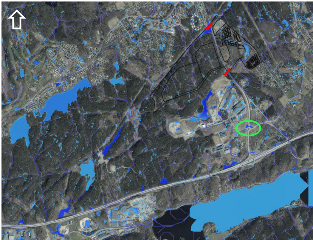
Figur 23. Tillgängligheten vid ett skyfall till planområdet (markerat i svart), grön cirkel visar en gång- och cykeltunnel under väg 535 och röda streck visar ungefärlig placering av de två trummorna som ägs av Trafikverket.
