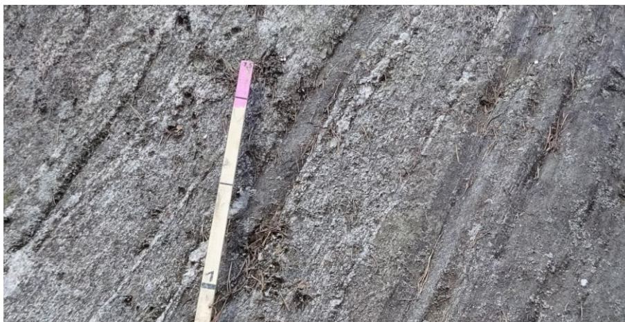
Bild 1 Detaljbild på berget där man ser bergets foliationen.
