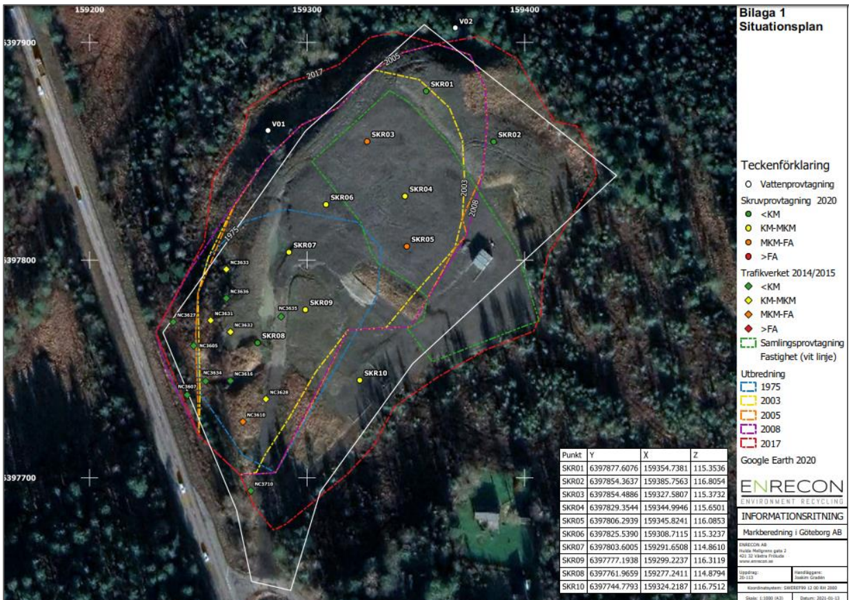
Figur 17. Läge för provtagningar genomförda i samband med framtagning av Vägplan för Väg 535 är markerade med NC36XX (se även kap.5.4), provpunkter från ENRECONs undersökning är markerade SKR01-SKR10 samt V01 och V02, (ENRECON, 2020).
