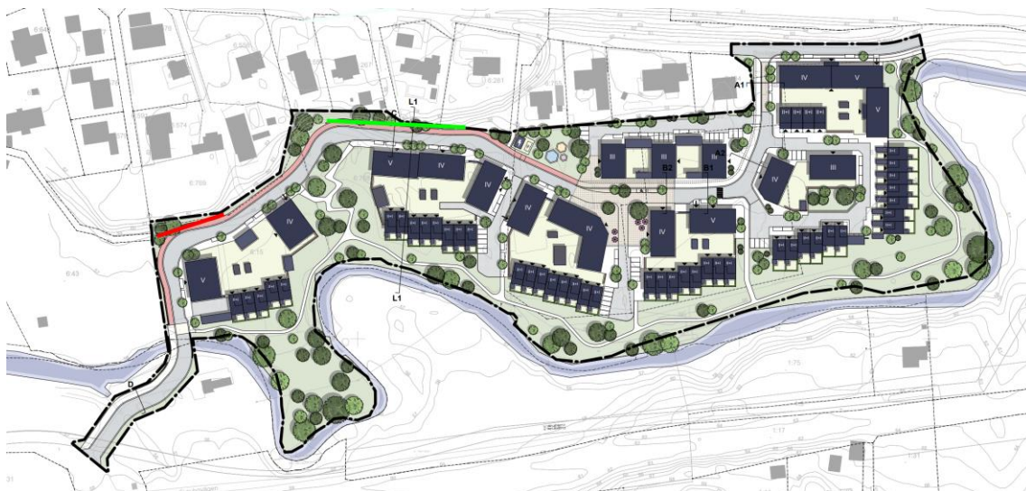
Figur 5 Röd markering anger slänt som återställs till nuvarande skick. Grön markering anger slänt som förstärks med stödmur, typ gabionmur eller motsvarande.
